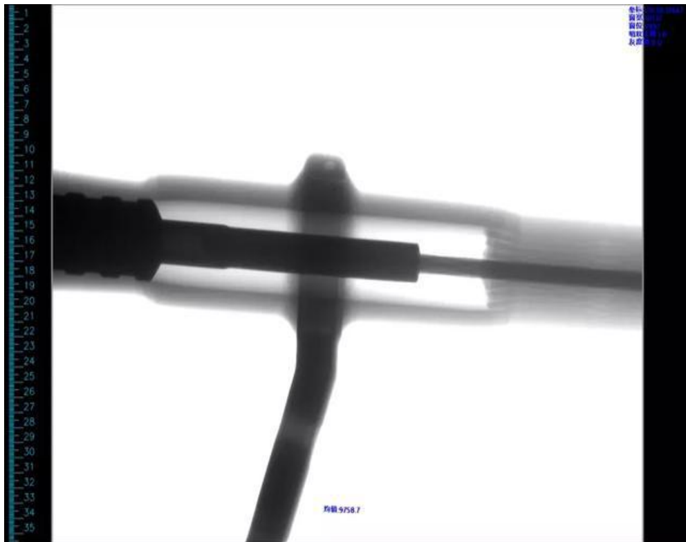
第3张 电压：150kV，可以观察到铝管压接状态
